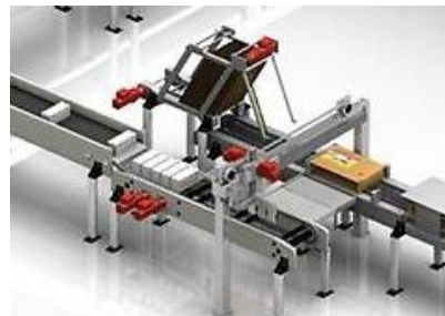
Getriebemotoren als Antrieb in einer Prozessstraße
