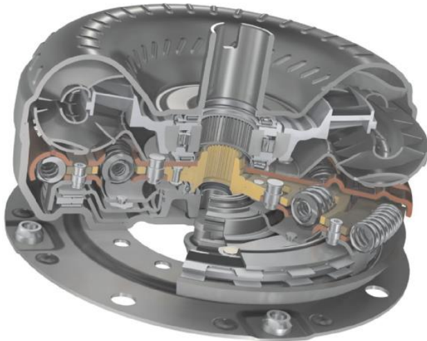
Wandler-Dämpfer: Vergleich Turbinentorsionsdämpfer (TTD) mit Zwei-Dämpfer-Wandler (ZDW) (oben) und Zwei-Dämpfer-Wandler von ZF (unten)
