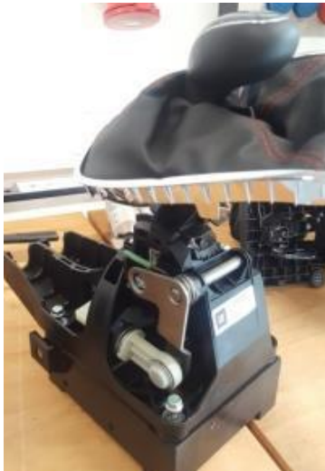
Shifter GM M32: Gangsperrmechanismus (oben) und Schalthebel mit Anschlüssen für die Schalthebel (unten)
