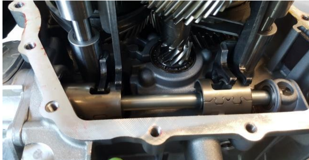
Shifter GM M32: Gangsperrmechanismus (oben) und Schalthebel mit Anschlüssen für die Schalthebel (unten)
