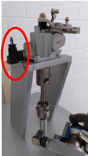
Shifter GM M32: Ausgebaut (oben) – Sensor Rot markiert– und Sensoraufbau (unten)
