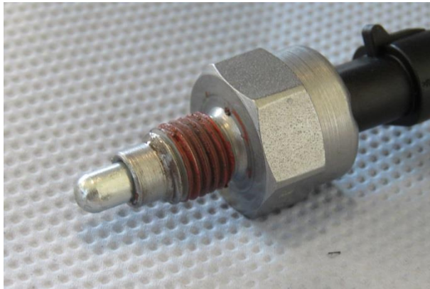
M32: Polyamid Dichtmasse des Rückwärtsgangensors (oben) und Gehäuse-dichtflächen mit Fettrückständen in Rot (unten)
