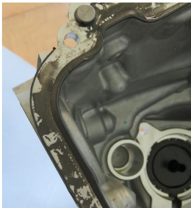
M1X/M22: O-Ring Dichtung des Shifters (oben)- und aushärtende Flüssigdichtung des Gehäuses (unten)
