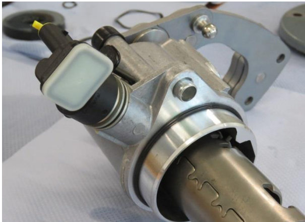
M1X/M22: O-Ring Dichtung des Shifters (oben)- und aushärtende Flüssigdichtung des Gehäuses (unten)
