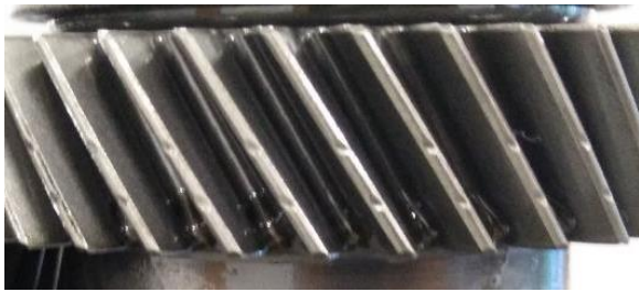
F40: Zahnmarken (oben) und aufwändige Verschraubung (unten)
