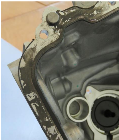
F40: Radialwellendichtring im Gehäuse (oben) und Getriebeteil mit aushärtender Dichtmasse (unten)
