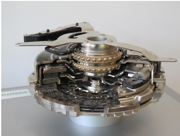
Doppelkupplung-Ausrücklager: Doppelkupplung (oben) und Zentralausrücker [a] und Hebelausrücker [b] (unten)
